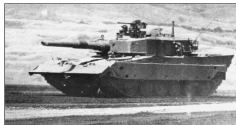
Японский ОБТ типа «90», оборудованный системой предупреждения об облучении лазером (датчик обнаружения лазерного излучения виден на штанге на крыше башни)
