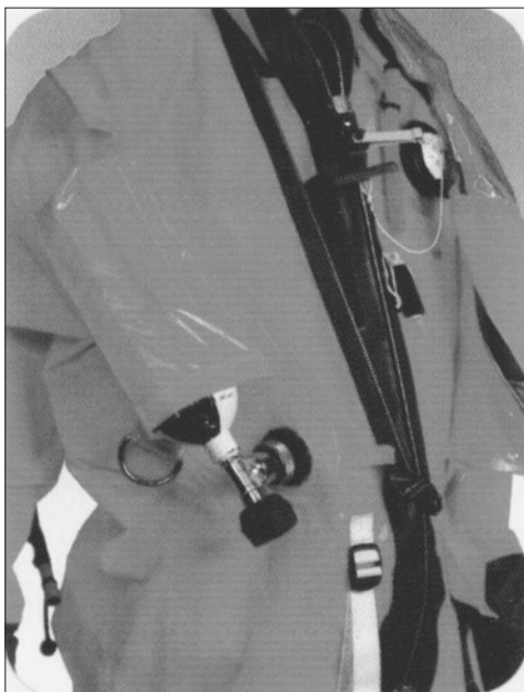
Крепление на гидрокомбинезоне ИССП типа SEIE Mk 10 баллона со сжатым воздухом
